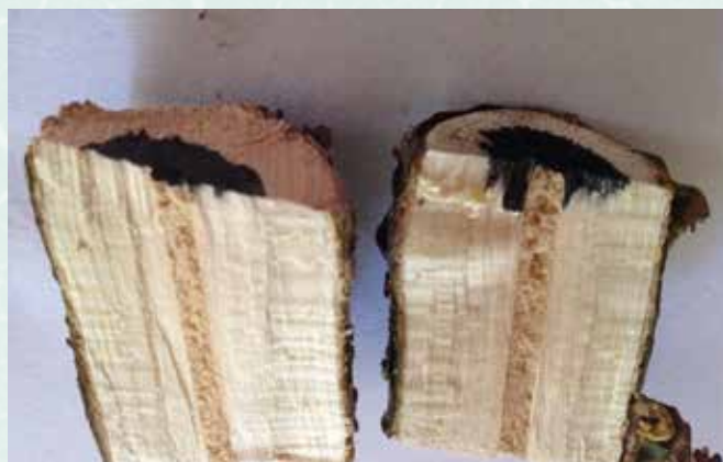
Efecto de BlocCade. Después de aplicar BlocCade la tinta no es capaz de penetrar dentro de la madera
